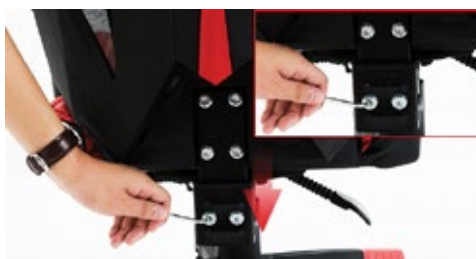
ENCAIXE O ASSENTO COM O ENCOSTO E PARAFUSE COM A CHAVE ALLEN, CONFORME IMAGEM ACIMA.
