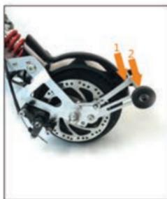
Segure o guidão com a mão esquerda, segure a parte traseira do assento com a mão direita, pressione (1) para destravar com o pé direito e pressione 2 para travar o apoio.
