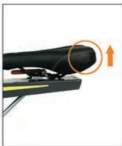
Levante a E-bike Ciclo segurando a parte traseira do assento com a mão direita, para que a roda de apoio possa ser colocada de modo correto no chão.
